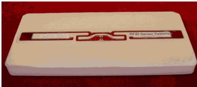
RFID-tag med temperatursensor
