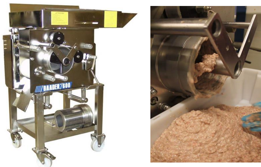
Figur 18. BAADER 600 båndseparator og produksjon av farse fra buklist.
