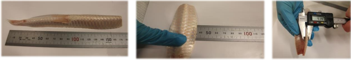
Figur 4. Metodikk for måling av lengde, bredde og tykkelse av buklist og bits and pieces.
