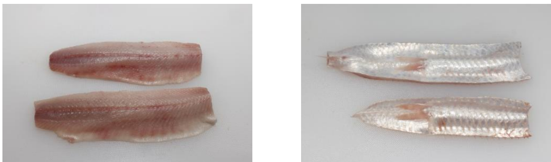
Figur 8. Utprøving av ulike innstillinger i filemaskin, vanlig skjæring (venstre) og ombygde guider (høyre).
