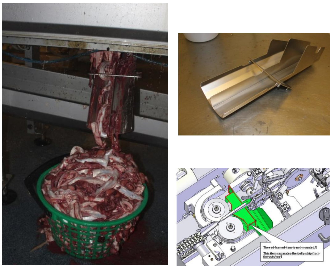
Figur 7. Sorteringsenhet for buklist som ble montert i filetmaskin. Kilde: Baader Norge.
