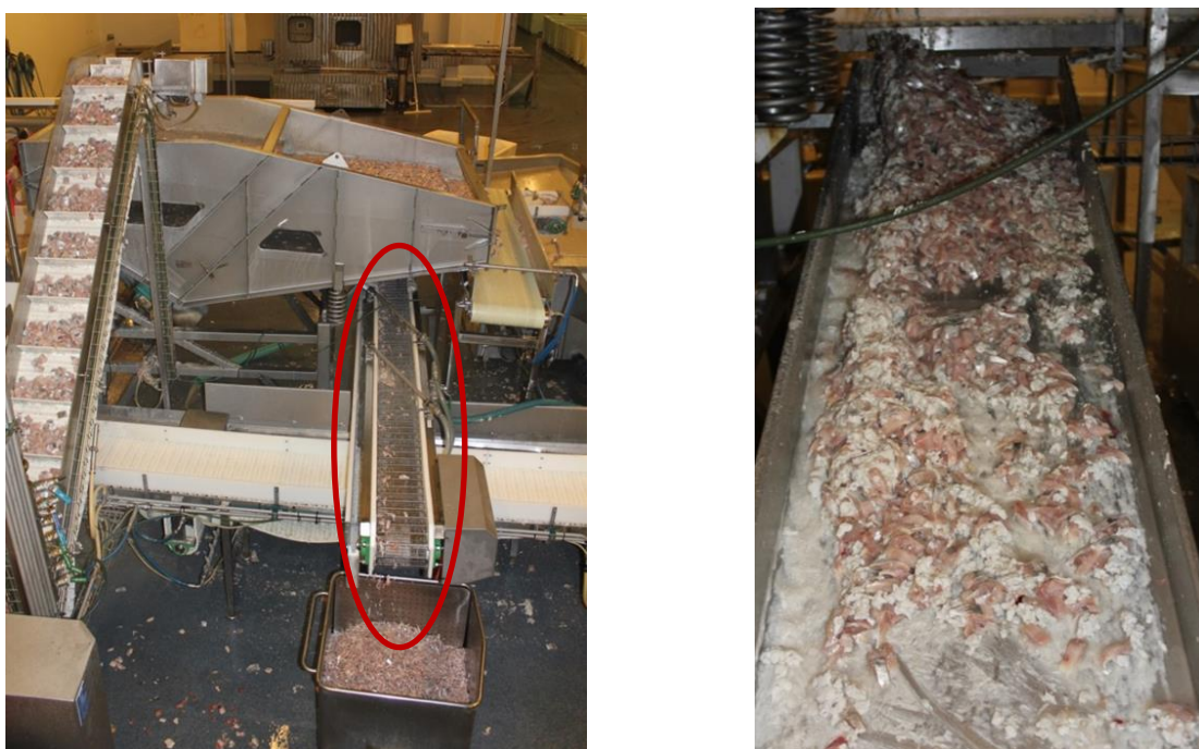
Figur 15. Nyutviklet sorteringsbånd for bits and pieces og biter av fett i avfallsrenna.
