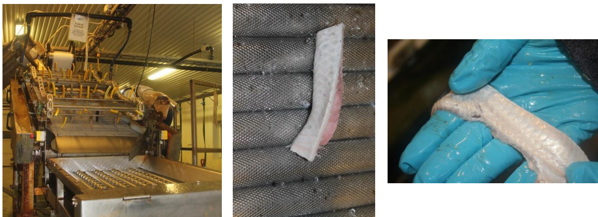
Figur 10. Uttesting av rensing av buklist på rensmaskin for blåskjell.
