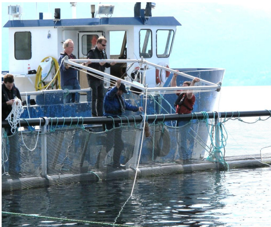
Bilde 2.4 Svingeren ble montert “opp ned” i en ramme som så ble senket til ca 15 m dyp i merden.
