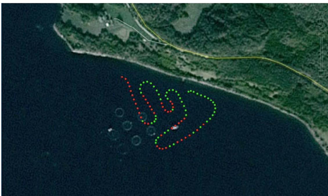
Figur 3.2 Viser “sedimentdata” langs noen transekter. Kurslinjen er delt opp i mindre partier og klassifisert i harde (rød) og bløtere (grønn) områder. Dette er så overført til et Google Earth bilde (hentet fra BioSonics oppsummeringsrapport, vedlagt).
