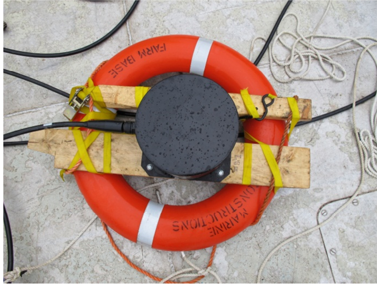
Bilde 2.3 Svingeren ble montert på en livbøye slik at den fløt.
