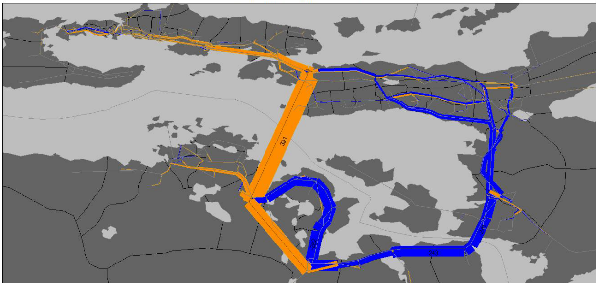
Figur III) Effekt av Borgundfjordtunnelen med fri passering. Maksimaltrafikktime 2014, morgenrush kl 0700-0800 (oransje = økning i biltrafikk, blå = reduksjon i biltrafikk)
