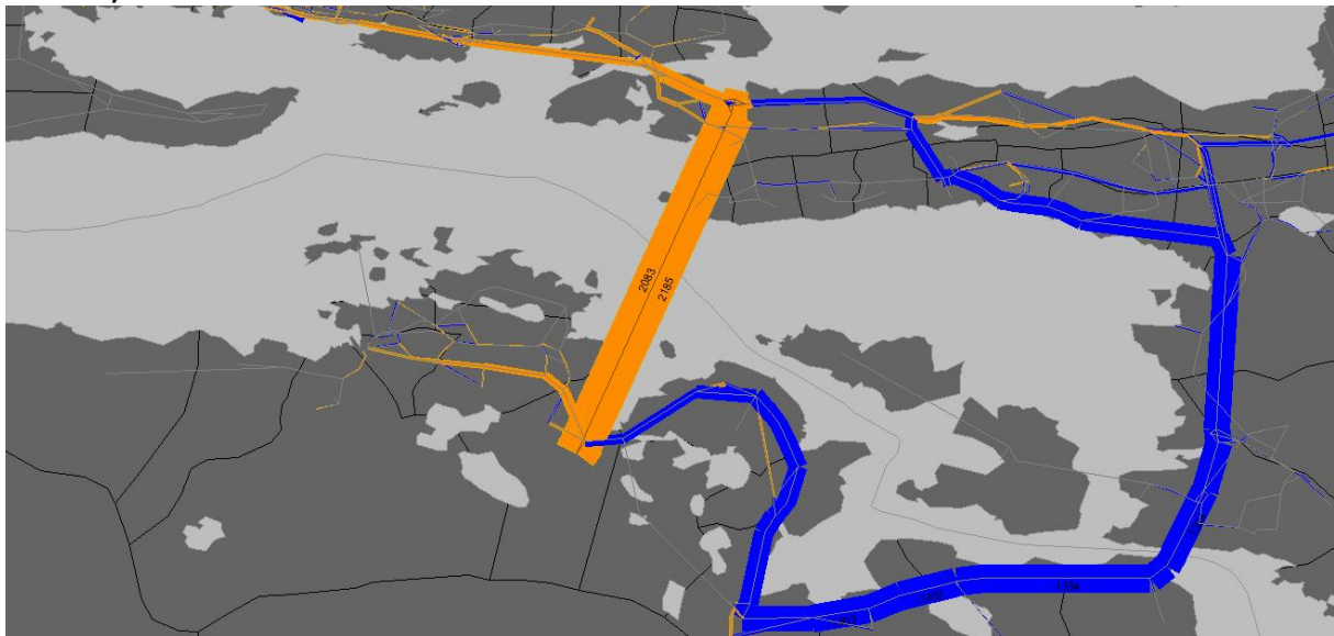
Figur 3-20 Effekt av Borgundfjordtunnelen (uten Veddemarktunnelen) med bompengesats på kr 20 (2014 prisnivå, fullpris) sammenliknet med referansesituasjonen (oransje = økning i biltrafikk, blå = reduksjon i biltrafikk)
