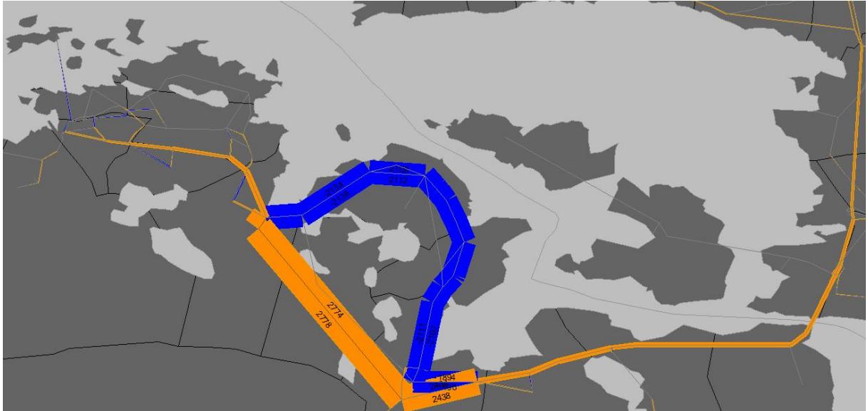
Figur 3-19 Effekt av Veddemarktunnelen (uten bompenger) sammenliknet med referansesituasjonen (oransje = økning i biltrafikk, blå = reduksjon i biltrafikk)
