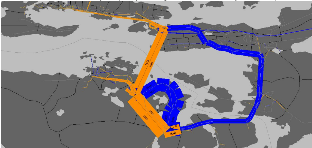
Figur 3-14 Effekt av Borgundfjordtunnelen med bompengesats på kr 35 (2014 prisnivå, fullpris) sammenliknet med referansesituasjonen (oransje = økning i biltrafikk, blå = reduksjon i biltrafikk)
