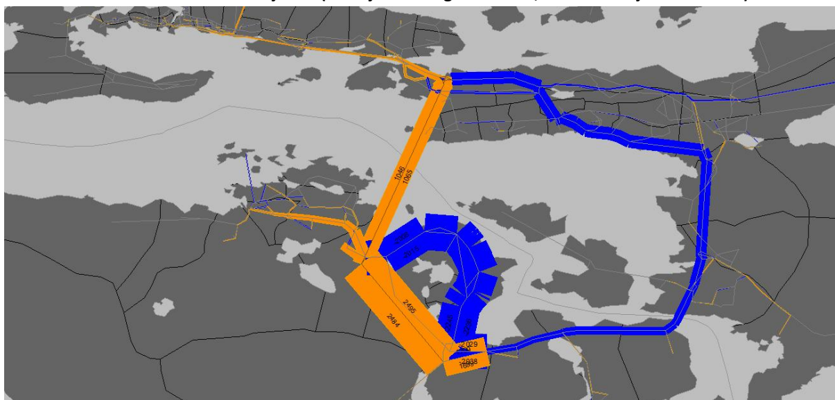
Figur 3-13 Effekt av Borgundfjordtunnelen med bompengesats på kr 50 (2014 prisnivå, fullpris) sammenliknet med referansesituasjonen (oransje = økning i biltrafikk, blå = reduksjon i biltrafikk)
