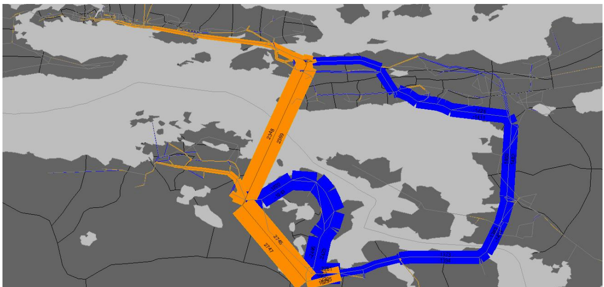
Figur 3-21 Effekt av Borgundfjordtunnelen med bompengesats på kr 20 (2014 prisnivå, fullpris) sammenliknet med referansesituasjonen (oransje = økning i biltrafikk, blå = reduksjon i biltrafikk). Følsomhetsanalyse med tids- og kostnadskoeffisienter som for 2001.
