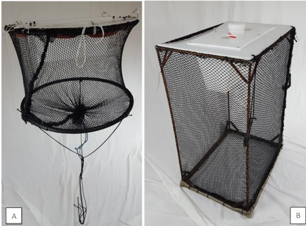
Figur 28 Prototype av flyteteine (a) og enkammersteine (b) produsert av Frøystad AS (foto: Frøystad AS)
