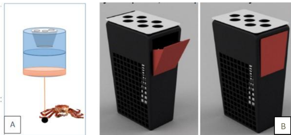
Figur 26 Illustrasjon over teiner som er fløytet over bunn (a) og glatte teiner som ikke skal gi kongekrabben tak til å klatre (b). Illustrasjoner er utarbeidet av Noodt og Reiding, ved Bjørn Føløide.
