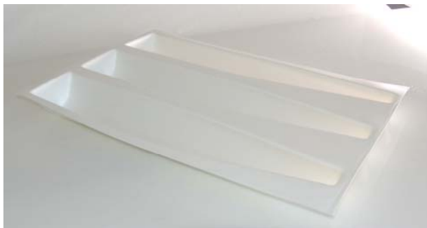
Bilde 2. Formvac's fryseformer til innfrysing av hårygger.
