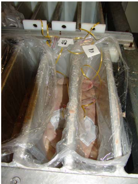
Bilde 6. Lever i vertikalfrysa med ilagte temperaturloggere.
