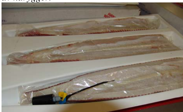
Bilde 4. Rygger med temperaturlogger pakka i fryseformer.
