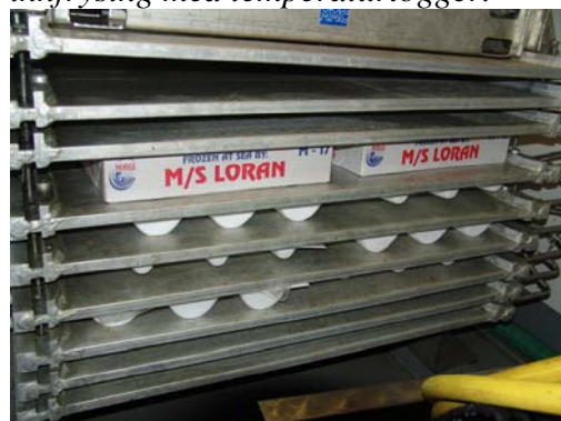
Bilde 5. Plassering av former og kartonger i horisontalfryser.
