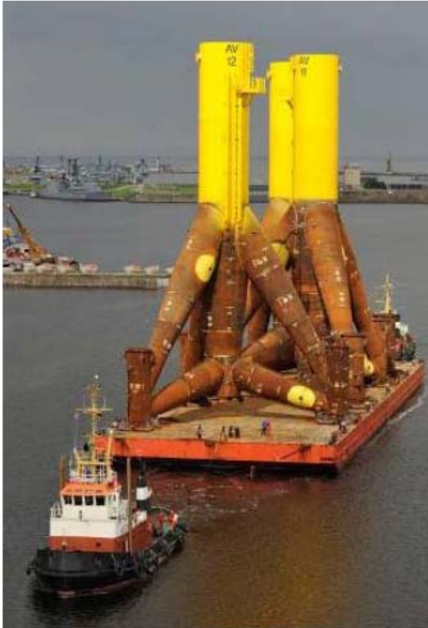
Figur 3.8 Vindmøllefundament til Alpha Ventus-prosjektet levert fra Aker Solutions Verdal.
