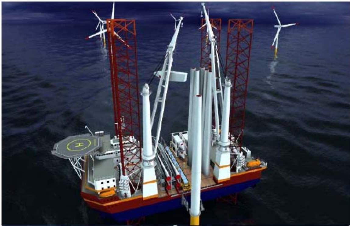
Figur 3.4 Illustrasjon av Master Marine sin jack-up rig Service Jack 2 for installasjon av vindmøller på Sheringham Shoal-feltet.
