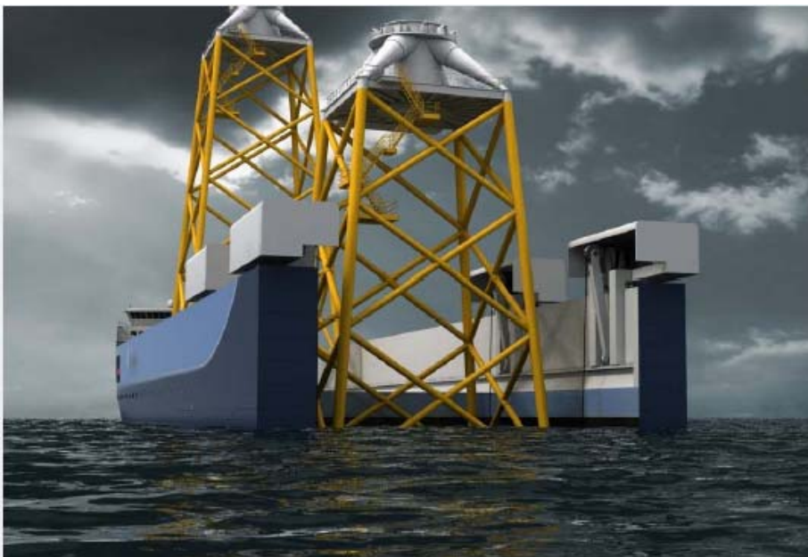
Figur 3.9 NorWind arbeider med utvikling av et skreddersydd fartøy for peling av bunnfester og installasjon av fundament.
